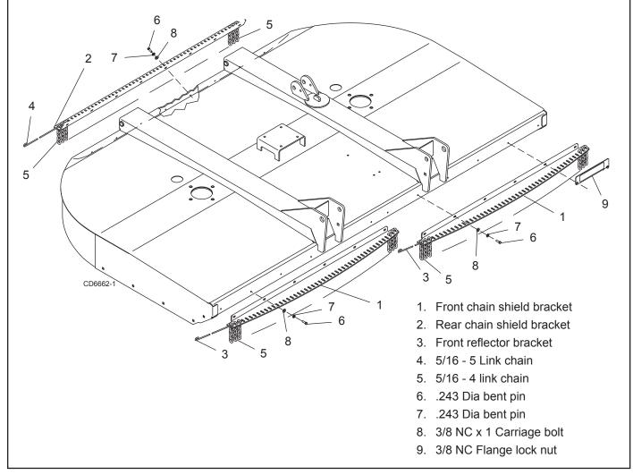
Figure 37. DS8.30 & DS10.40 Optional Chain Shielding Installation
