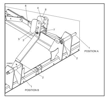
Figure 3. DS10.40 Standard and Quick Hitch Connection
