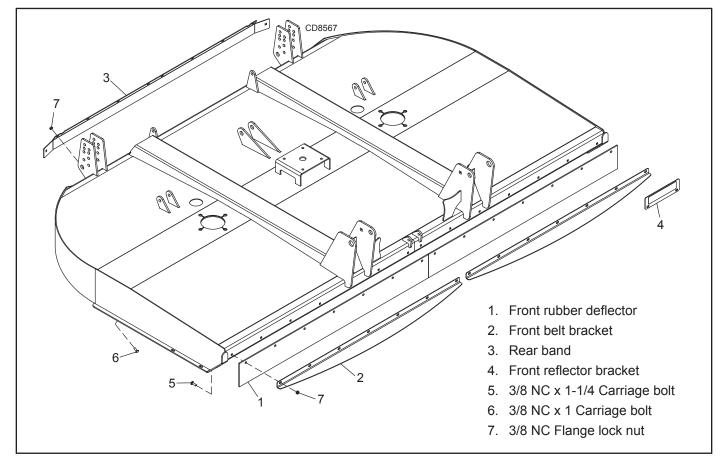
Figure 36. DS8.30 & DS10.40 Rubber Shield Installation
