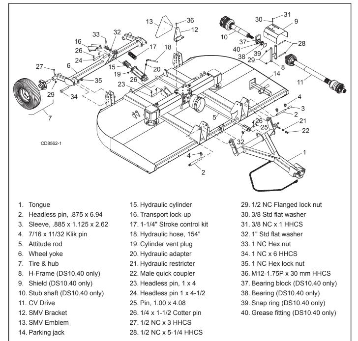
Figure 34. DS8.30 & DS10.40 Pull-Type Assembly
