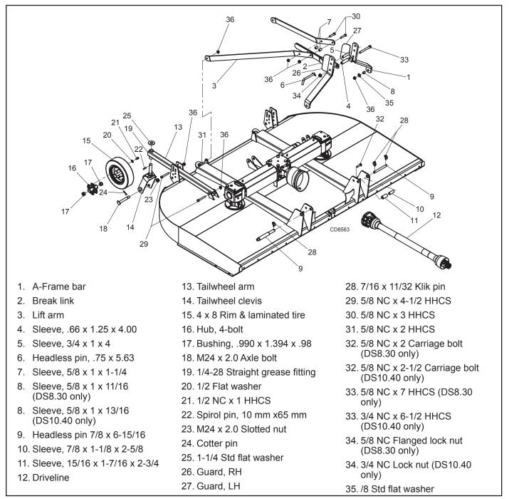
Figure 35. DS8.30 & DS10.40 Mounted Assembly
