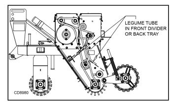
Figure 22. Legume PVC Tubes
